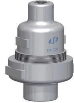
EA-200 es un eliminador de aire proyectado especialmente para la desaireación de líneas de agua, a través de mecanismo de flotador que modula la apertura del asiento de manera a eliminar bolsillos de aire que comprometen la circulación de líquido, entre otros problemas. Puede ser suministrados con las conexiones roscadas BSPT (BS 21) o NPT (ANSI B1.20.1).
